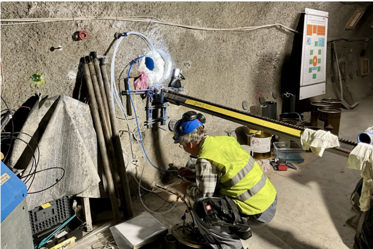
Figure 3: HE-E: U. Mäder injecting resin into BHE-E3 (J. Windisch, swisstopo).
